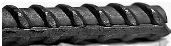
Рис. 3. Внешний вид образца арматуры № 12 класса Ат800 вблизи места излома
